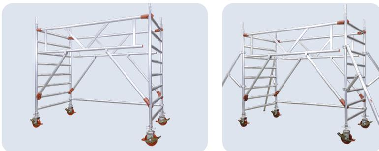
Som en hjælp under opstilling kan to platforme anvendes forskudt i henholdsvis 1 og 2 meters højde. Stående på den nederste af platformene vil du nu sikkert kunne montere de næste siderammer over hornene på de forrige rammer. Husk at sikre disse med clips.
